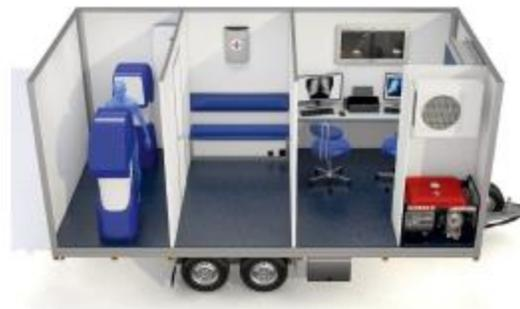
La sala de fluorografía móvil podría basarse en un furgón isoterma de múltiples secciones hecho en Rusia, o el país del comprador o en diferentes remolques y equipados con todos los sistemas de soporte de vida necesarios, muebles, médicos y equipos auxiliares.
