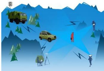
El sistema de monitoreo de radio automatizado AREAL-2 es un caso particular del sistema AREAL. Está destinado a la monitorización de radio periódica o única en un área confinada con un entorno de radioelectrónica desconocido. Para este propósito, el Sistema incluye estaciones móviles y transportables de monitoreo de radio y búsqueda de dirección. Para una localización más precisa de las fuentes de emisión de radio, el Sistema puede incluir buscadores de dirección de manpack.
