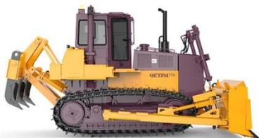
CHETRA T15 es una máquina de tracción media para construcción industrial, de petróleo y gas, ingeniería hidráulica y minería. La suspensión semirrígida de tres puntos con un eje extendido para balanceo de carros y micro-suspensión de la rueda de tensión proporciona altas características de tracción, reducción de las cargas de choque en el sistema de tren de rodaje y mejora de las condiciones de trabajo del operador.
